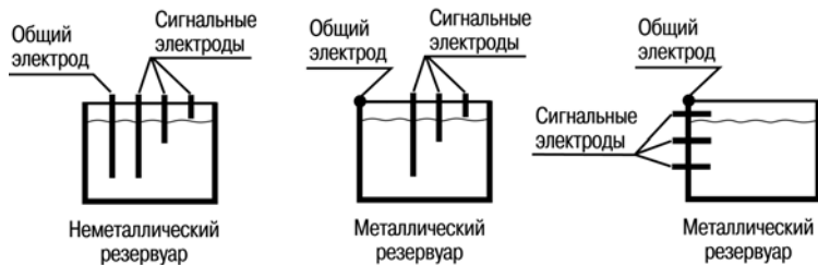
Рисунок 5.4 – Примеры установки кондуктометрических зондов
